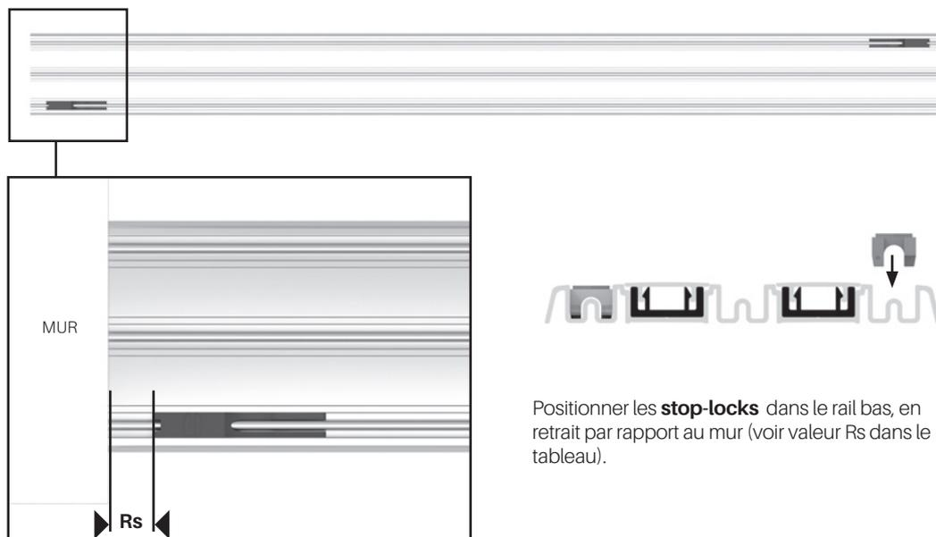
Positionner les **stop-locks** dans le rail bas, en retrait par rapport au mur (voir valeur Rs dans le tableau).
