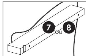
⚠ Ne pas pincer les câbles au moment de visser. Faire passer le fil de raccordement du profil LED (V) dans le trou traversant l'épaisseur du tasseau 7 ou 8 pour éviter de le pincer.
