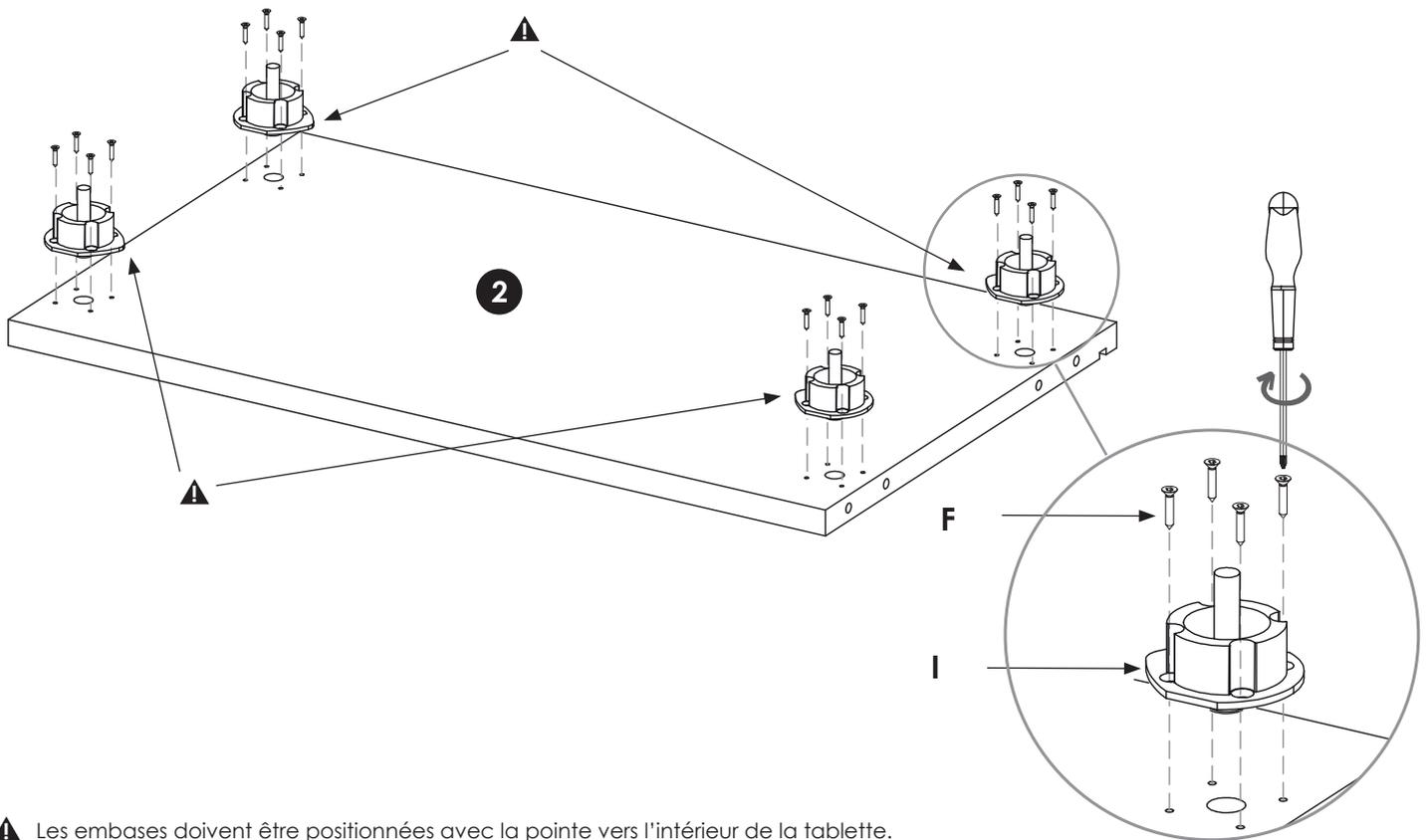
⚠ Les embases doivent être positionnées avec la pointe vers l'intérieur de la tablette.
