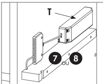
⚠ Connecter le profil LED (V) au boîtier de raccordement. Le convertisseur et le boîtier de raccordement (T) peuvent se poser sur la pièce 7 ou 8.
